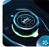
Le auto trasformate con sistemi ad iniezione in fase gassosa della famiglia Sequent sono dotate di un commutatore a pulsante con avvisatore acustico (Buzzer), sul quale è integrato un indicatore di livello di gas formato da 4 LED verdi.
